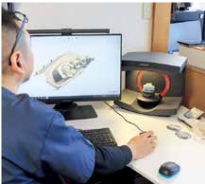
歯科技工用スキャナーでの作業の様子。3DCADで設計することにより、従来の手作業では製作できなかった新しい材料を削り出すことが可能となる。
