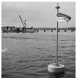
NTTドコモとアンデックスの共同開発による水温センサー付きブイ。海水温のデータをクラウド経由で蓄積し、カキ養殖の生産管理に利用している。
