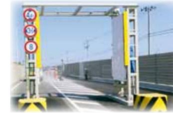
据置型放射線検知装置
